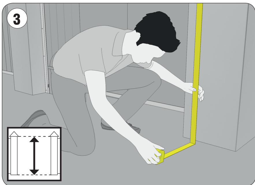
Фото результата замера высоты проема (Н).
